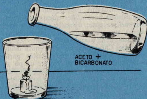
Fig. 2 - La bottiglia va inclinata in modo da non lasciar uscire la soluzione di aceto e bicarbonato. Soltanto l'anidride carbonica uscirà facendo spegnere la fiamma della candela.
