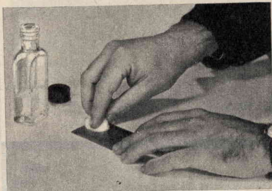
Fig. 1 - Prima cosa da farsi per ottenere il circuito stampato è quella di pulire la superficie di rame mediante un batuffolo di cotone impregnato di « pulitore ».
