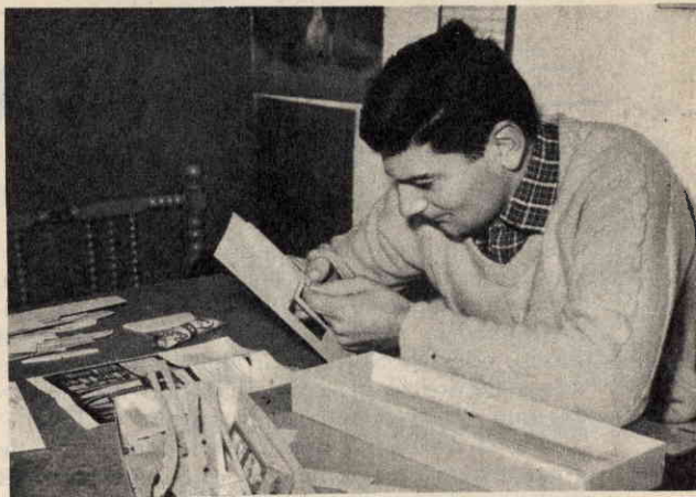
Fig. 1 - Tutte le parti componenti sono tracciate, mediante incisione, su fogli di legno. Per ricavarle basta agire con la sola pressione delle dita.
