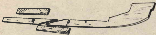
Fig. 4 - L'asse centrale del modello deve essere rinforzato al centro, incollando due listelli di legno.
