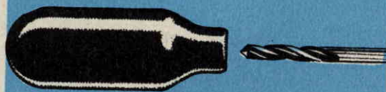
Fig. 3 - La camera di combustione del razzo è ricavata da una bomboletta di gas liquido per accendisigari. Unico adattamento è quello di aprire il foro della bocca di scarico con un trapano.
