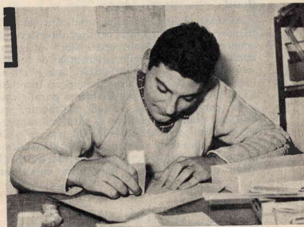
Fig. 2 - Tutti i pezzi di legno, prima di essere uniti tra di loro, vanno accuratamente lisciati ai bordi mediante impiego di cartavetrata.
